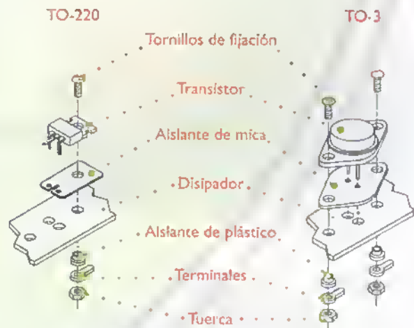
Figura 6.12. Montaje de transistores de potencia
